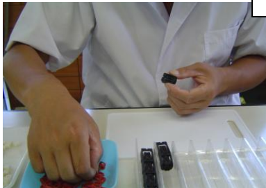
①ゴムのパッキンを取り付け 器具で奥に押し込む
